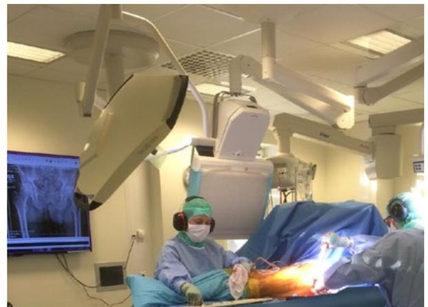
L' **Operio** **CEILING** permet de gagner un espace important au sol, et n'interfère pas avec les équipements existants. Grâce à son bras extensible, il peut facilement être ajusté manuellement et positionné à proximité de la table d'opération et du patient. Il est tout aussi facile de le déplacer lorsqu'il n'est pas utilisé en le poussant vers le plafond.
